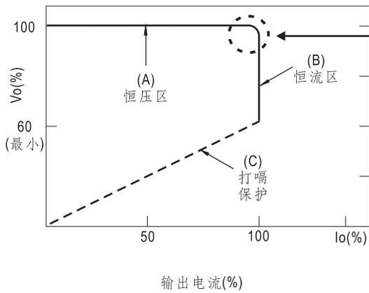
在恒流区,驱动器的最高输出电压取决于终端系统的配置。如有搭配使用问题,请洽询明纬
