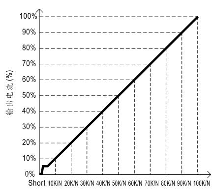
备注: 1. 最小调光比例约为8%左右, 当输出电流0%<iout<8%, 输出电流精度不做定义。
